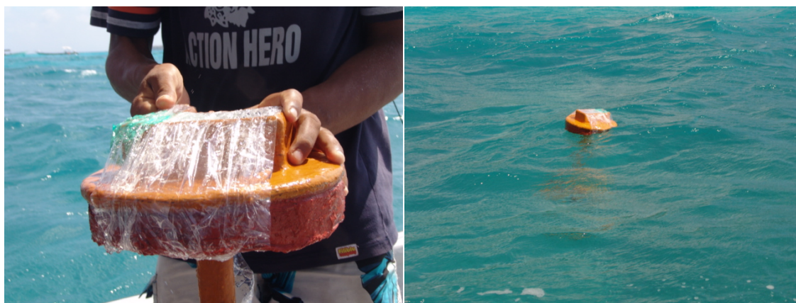
Figura 6-18 Medición de la dirección y velocidad de la corriente
