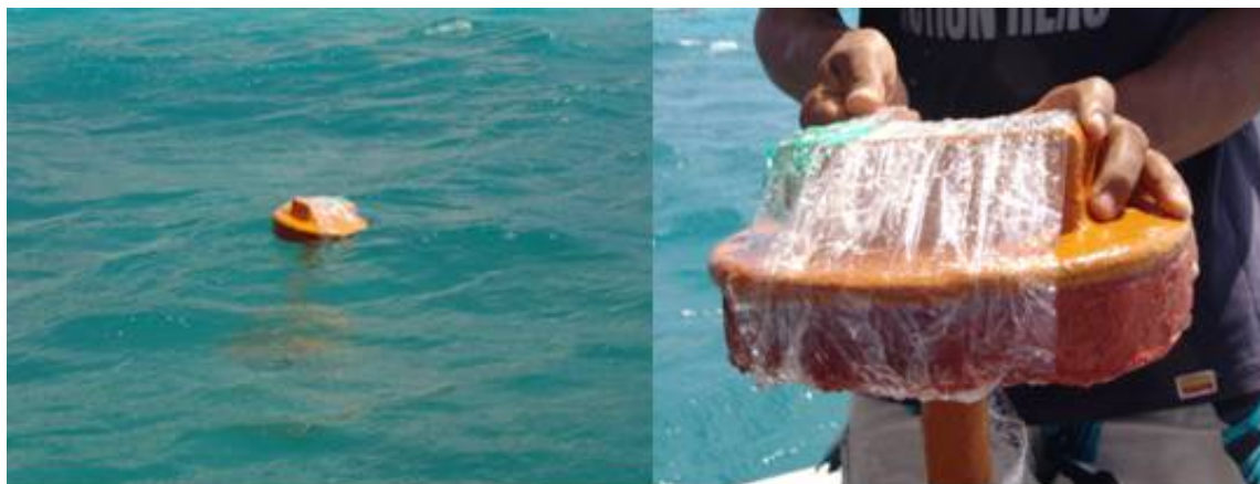
Figura 5.1 Medición de la dirección y velocidad de la corriente
