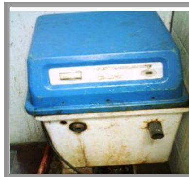
Foto 3. Dispositivo para la Extracción de Plata.
